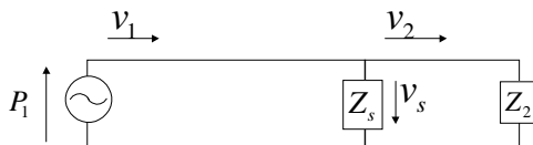
Fig. 9 ダクトの等価回路
